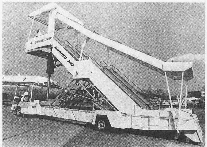
Bild 10. Prototyp der neuen fahrbaren Passagiertreppe. Die oberste Plattform kann bis auf rund 5,50 m gehoben und seitlich um 30^\circ geschwenkt werden
