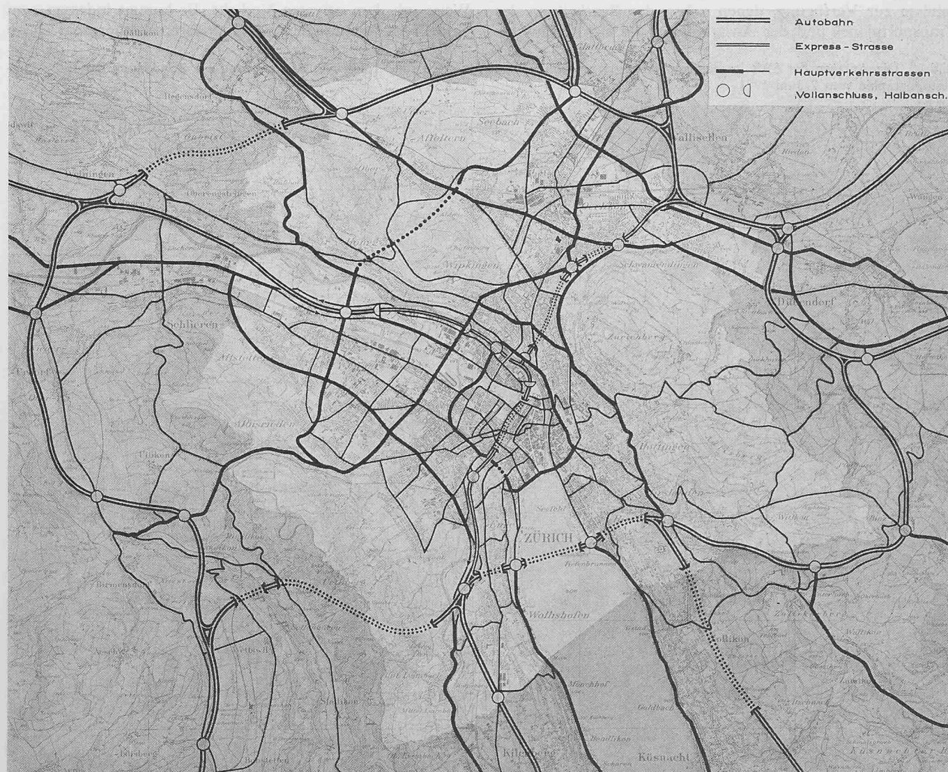
Das Strassennetz im engeren Vorortsgürtel von Zürich. Massstab rund 1:100 000. Reproduziert mit Bewilligung der Eidg. Landestopographie vom 2. Juni 1971
