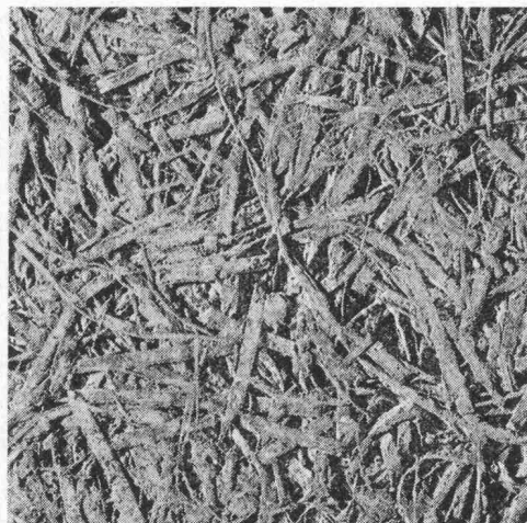
Struktur einer unbeschichteten Heraklith-Leichtbauplatte
