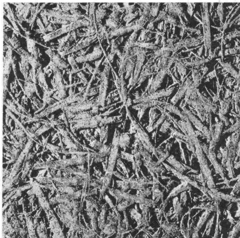
Struktur einer unbeschichteten Heraklith-Leichtbauplatte
