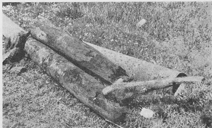
Bild 7. Auswirkungen von aggressivem Grundwasser auf verzinkte Stahlrohre
