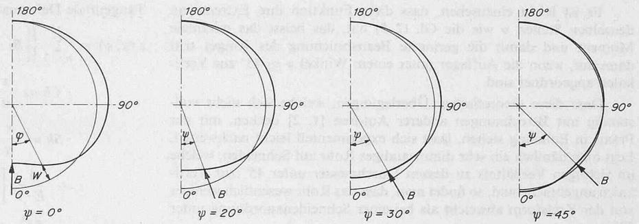
Bild 3. Deformationskurven des Ringes. Belastung durch Eigengewicht
