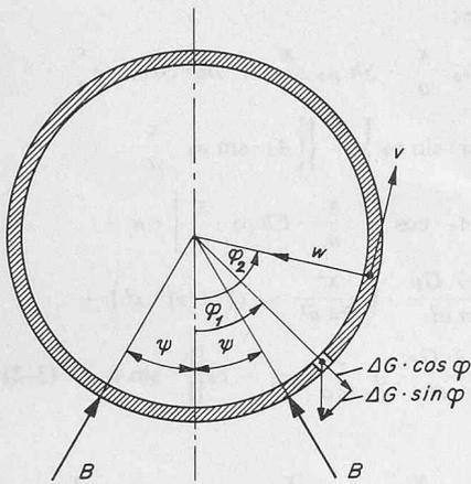
Bild 2. Eingeführte Kräfte und Koordinaten am Ring
