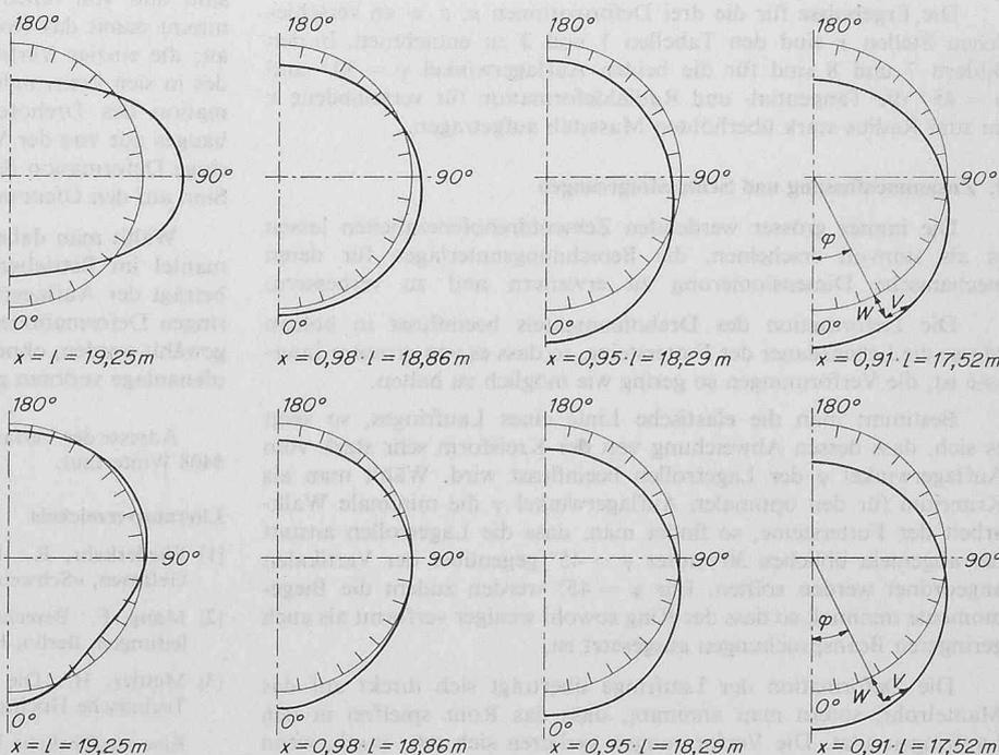
Bild 7. Deformationskurven des deformiert eingespannten Rohres.  $\psi = 30^\circ$ ,  $v_x = l = v_R$ ,  $w_x = l = w_R$ . Belastung durch Eigengewicht und Futtersteingewicht
