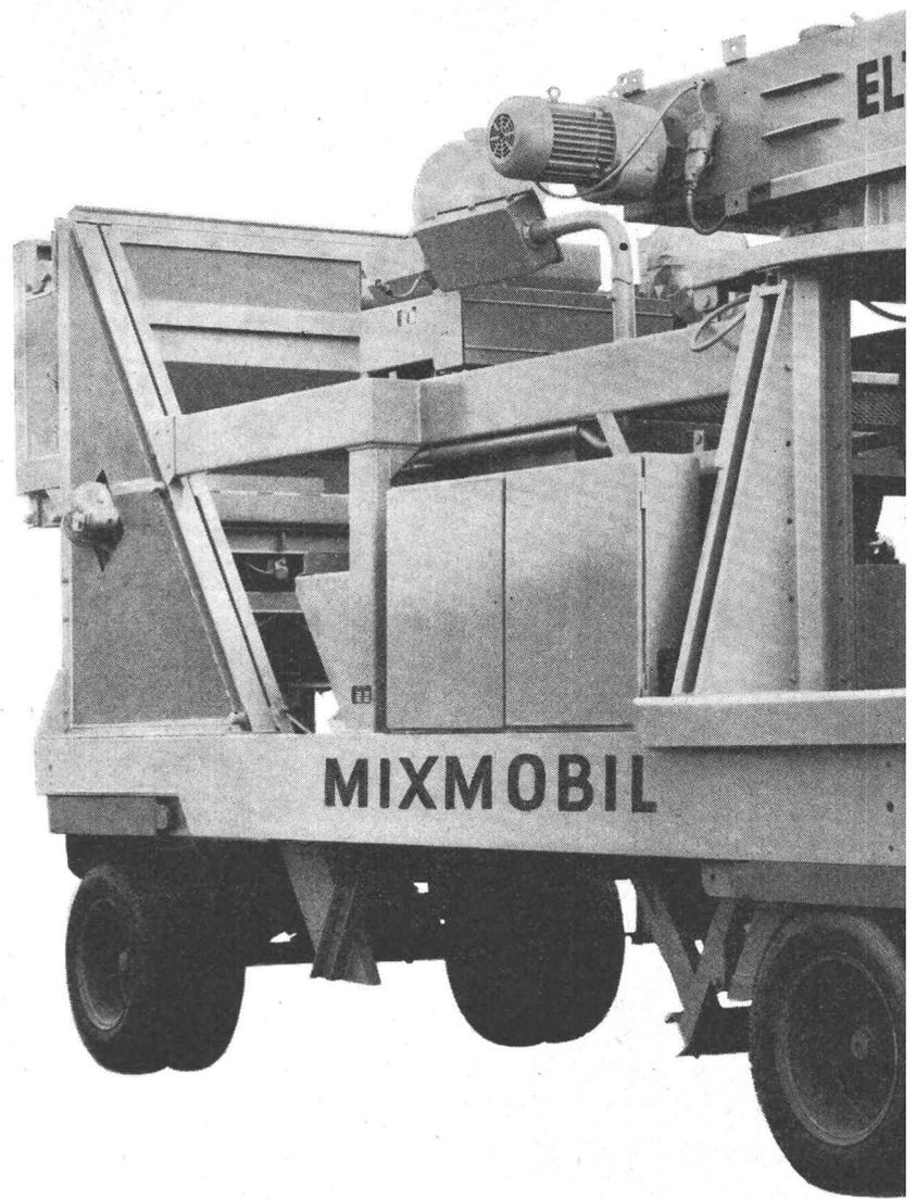
Stundenleistung 20-25 m<sup>3</sup>. Montage und Demontage kurzfristig ohne Kranhilfe. Alle Teile sind auf einem Rahmen vereint und anschlussfertig installiert. Elba-Zwangsmischer mit 4-Sekunden-Schnellentleerung garantiert Qualitätsbeton. Einige Hundert stehen bereits im Betrieb! Abgabemöglichkeiten wählbar in Krankübel, Betonpumpen, LKW, Dumper, Transportmulden. Keine Grube, Sichtkontrolle beim Mischvorgang.
