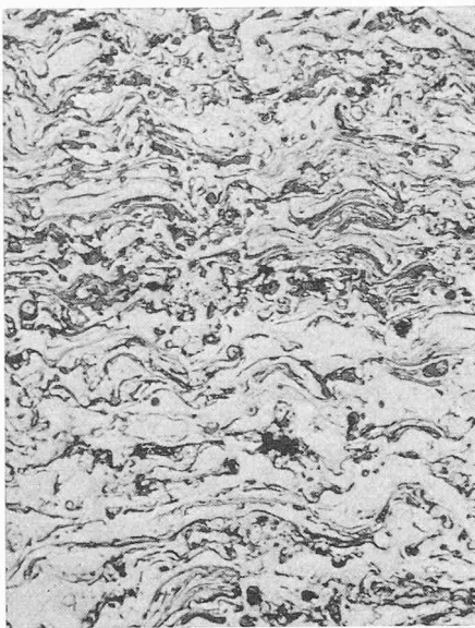
Bild 12 (links). Flammgespritzter rostfreier Stahl, stark mit Oxyden durchsetzt, ungeätzt. Vergrößerung 60fach
