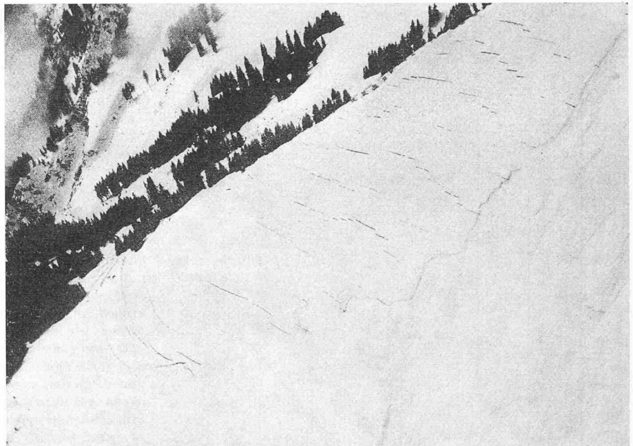
Bild 2. Lawinenniedergang vom 21.3.67 östlich der stark eingeschnittenen Lawinerverbauung Tanngrindel/Brienz. Trotz des offenen Verbaungrandes breitete sich in diesem Fall das Schneebrett mit einer Breitenentwicklung von 1500 m nicht in die Stützverbauung hinein aus. Die seitlichen Anrisslinien fallen mit dem Verbaungrand zusammen; die stabilisierende Wirkung der Stützverbauung auf die Schneedecke ist eindeutig sichtbar. Aufnahme 21.3.67 von W. Schwarz
