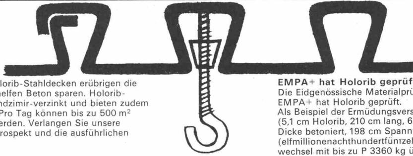
Holorib hilft rationalisieren! Holorib-Stahldecken erübrigen die Schalung, die Armierung und helfen Beton sparen. Holorib-Stahldecken sind beidseitig sendzimir-verzinkt und bieten zudem alle 15 cm eine Ankerschiene. Pro Tag können bis zu 500 m<sup>2</sup> Holorib-Stahldecken verlegt werden. Verlangen Sie unsere Referenzen, den technischen Prospekt und die ausführlichen EMPA-Testresultate.
