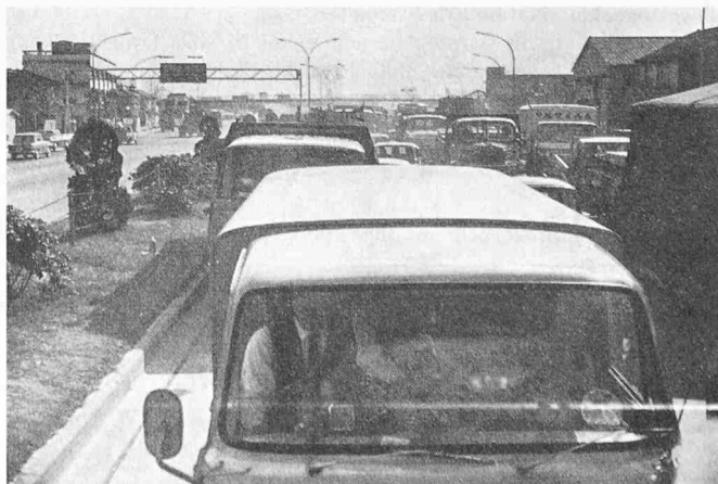
Bild 2. Schwerververkehr auf einer japanischen Expressstrasse. Auf dem Nagoya-Kobe Expressway schwankt der Anteil des Schwerverkehrs zwischen 39,8 % (Toyonaka) und 67,2 % (Ritto)
