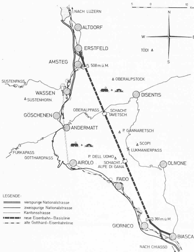
Bild 3. Variante A, Übersichtsplan. Dem Strassenverkehr stehen Basistunnel, rollende Strasse Göschenen—Airolo und Pass zur Verfügung. Der Bahn dienen die alte Gotthardlinie und der Basistunnel
