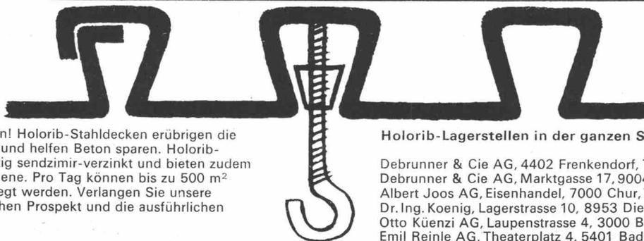
Holorib hilft rationalisieren! Holorib-Stahldecken erübrigen die Schalung, die Armierung und helfen Beton sparen. Holorib-Stahldecken sind beidseitig sendzimir-verzinkt und bieten zudem alle 15 cm eine Ankerschiene. Pro Tag können bis zu 500 m<sup>2</sup> Holorib-Stahldecken verlegt werden. Verlangen Sie unsere Referenzen, den technischen Prospekt und die ausführlichen EMPA-Testresultate.
