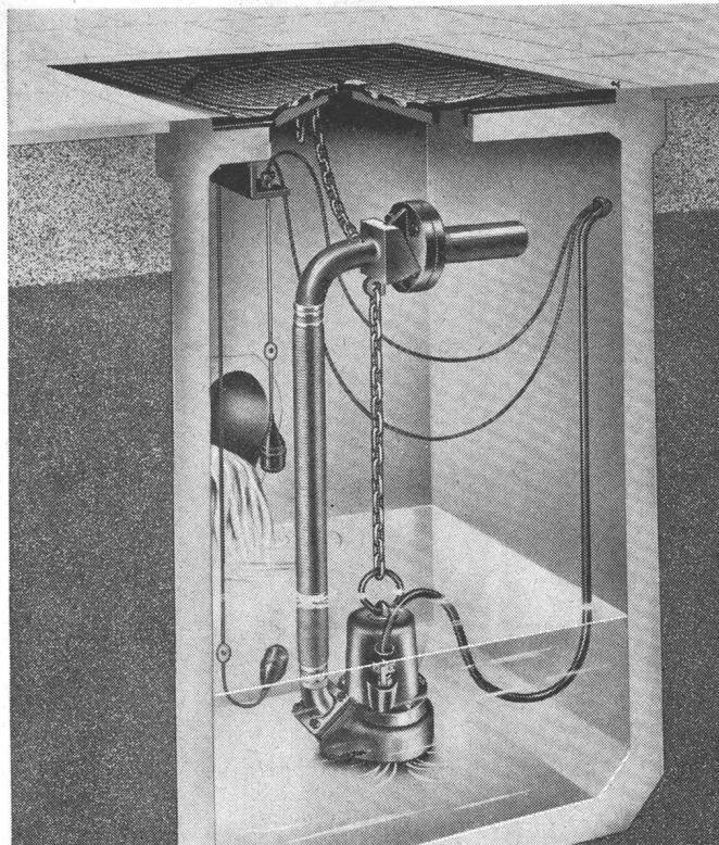
Vertikale Abwassertauchpumpe Robot Modell RW
