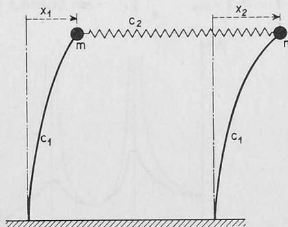
Bild 2. Schwinger mit Freiheitsgrad zwei;
