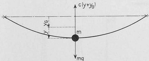
Bild 1. Schwinger mit Freiheitsgrad eins;
