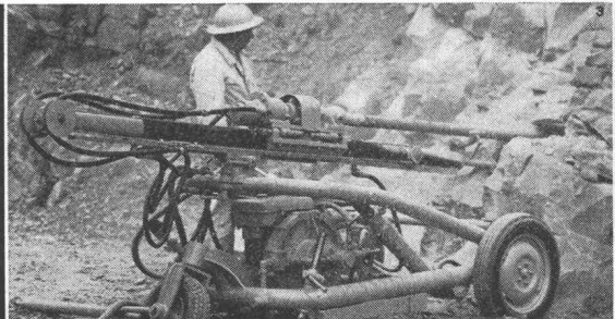
Grosslochbohrwagen mit hydraulischem Antrieb für Lochhämmer
