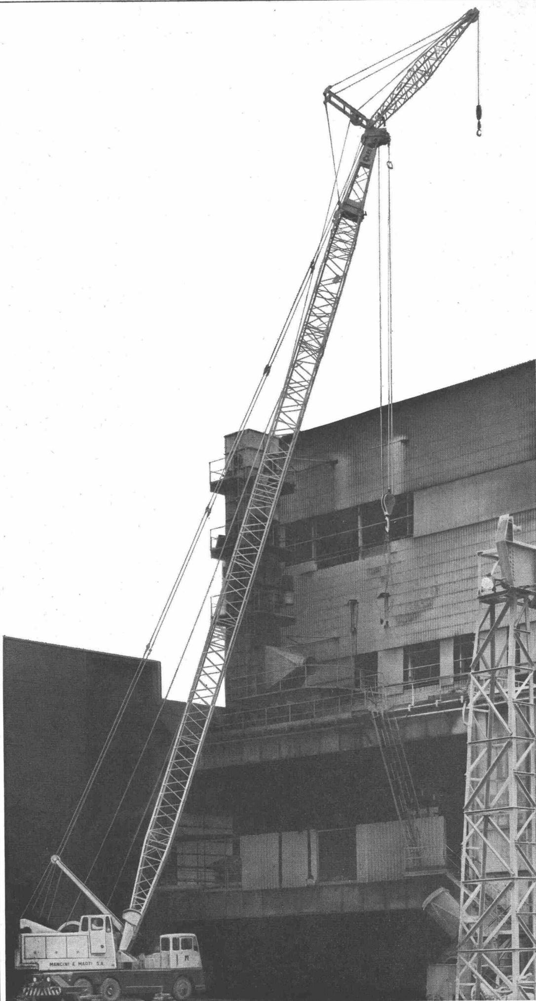
Alle Coles-Krane arbeiten dieselelektrisch. Schwerste Lasten können so millimetergenau und erschütterungsfrei abgesetzt werden. Der Kranführer schätzt die einfache, betriebssichere Bedienung.
