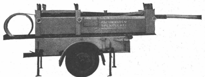
Seitenansicht der vollautomatischen Rinnenziehmaschine zur Herstellung von Dachrinnen in jeder gewünschten Länge direkt auf dem Bauplatz. Leistung 150 m per Stunde!
