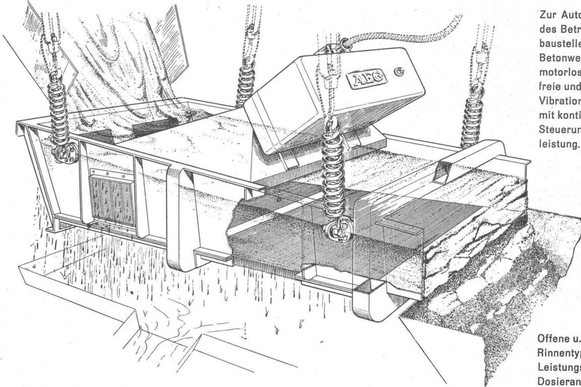
Zur Automatisierung des Betriebes auf Grossbaustellen, in Kies- und Betonwerken durch motorlose, wartungsfreie und verschleissfeste Vibrationsfördergeräte mit kontinuierlicher Steuerung der Förderleistung.
