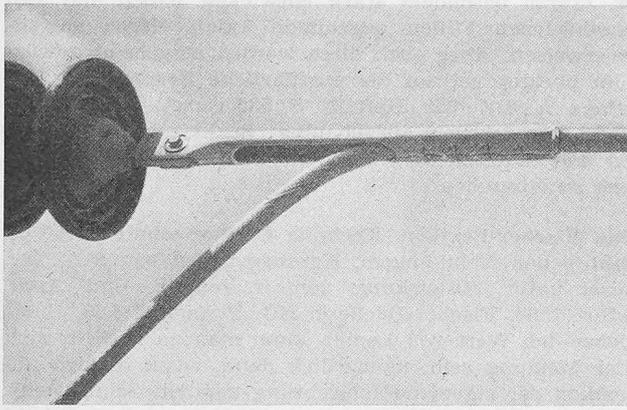
Fig. 50. Pince d'ancrage à corde passante
