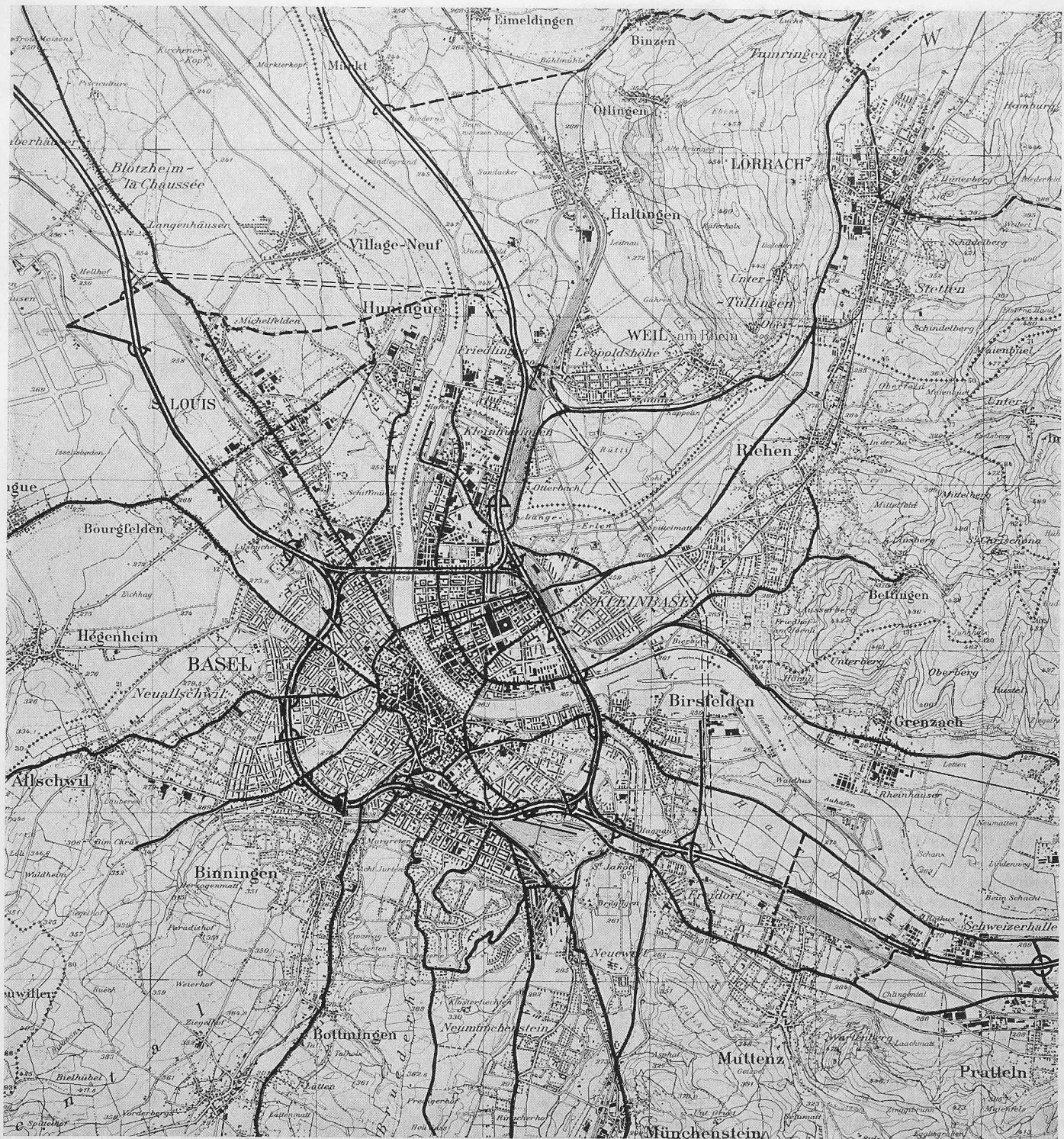
Bild 4. Vorschlag der Fachverbände (B. I. A., BSA und FSAI) für einen Autobahnring mit Anschluss an die deutsche Autobahn in der Fortsetzung der Innern Osttangente längs der Westseite der Gleisanlagen der Deutschen Bundesbahn. Masstab 1:70 000
