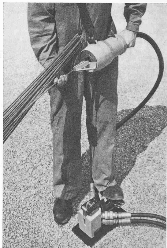
Bild 8. Hydraulisches Stauchwerkzeug mit Fusspedal-Bedienung, kleinerer Typ für Draht \phi bis 7 mm
