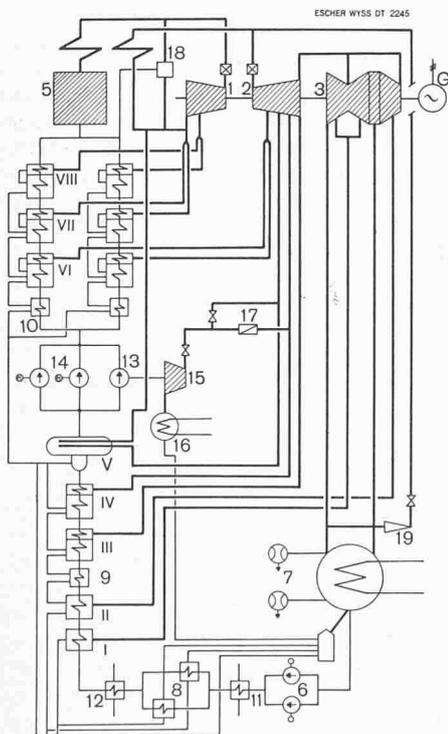
Bild 20. Schaltschema der Turbogruppe des Kraftwerkes Baudour
