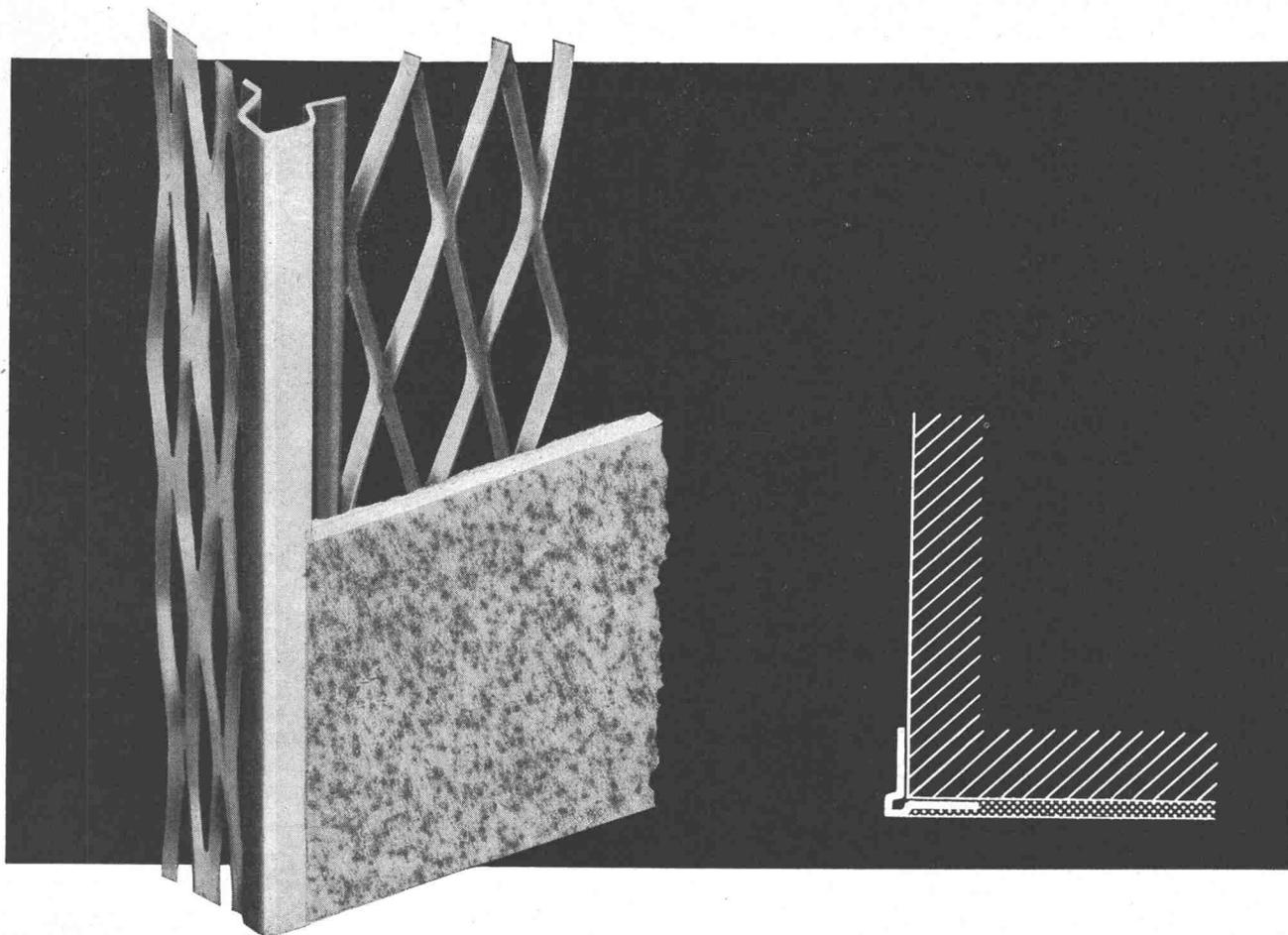
Mauerkanten werden oft leicht beschädigt, HESCO-Eckschutzleisten schützen Mauerkanten vor jeder Verletzung. Das feingliedrige, maschenartige Streckmaterial zu beiden Seiten der Schutzkante verbindet sich vollkommen mit dem Mörtel. Die Eckschutzleiste ist promatverzinkt, rostet also nicht. Lager-Längen 150, 180 und 200 cm in Bündeln à 10 Stück.
