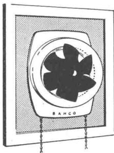
Der BAHCO-SILENT kann in Fenster mit Einfach- oder Doppelverglasung eingebaut werden. **Keine Distanzringe** notwendig. Das innere Glas muss jedoch 4 mm dick sein und der Abstand zwischen Fensterrahmen und Ventilator 10 cm betragen.
