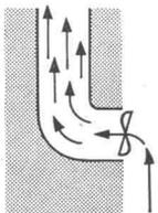
Der Querschnitt soll quadratisch oder rund mindestens dem  $\varnothing$  des Flügelrades entsprechen, beim BAHCO-SILENT also 15 cm, besser 15 x 20 cm. Das Schachtknie unterkant Eintrittsöffnung muss eine gute Kurvenabrundung aufweisen.
