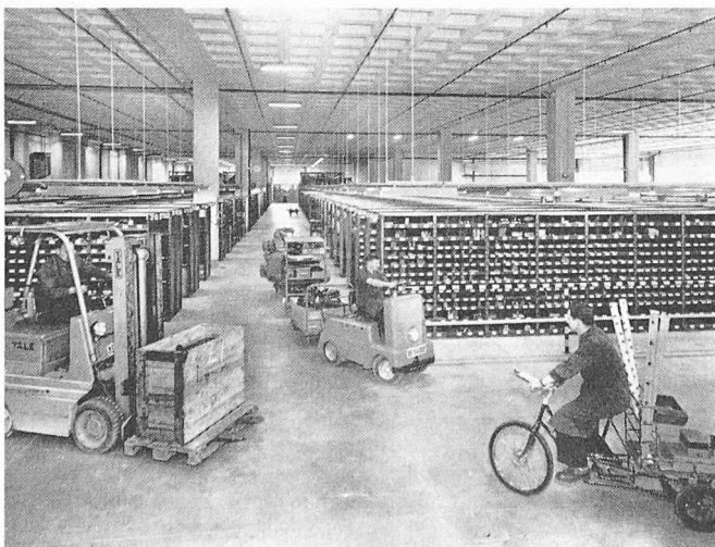
Bild 19. Im neuen, modern organisierten Ersatzteillager sind auch Transportprobleme rationell gelöst worden. Kleinere Aufträge werden per Dreirad zusammengestellt, ohne dass der Lagerist abzusteigen braucht. Die nötigen Formulare hat er vor sich auf dem Lenker
