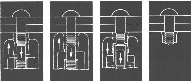
Das Spezialwerkzeug hält sich am Huckbolt-Bolzen fest. Durch Zurückziehen des letzteren werden die zu verbindenden Teile fest zusammengeklemmt.
