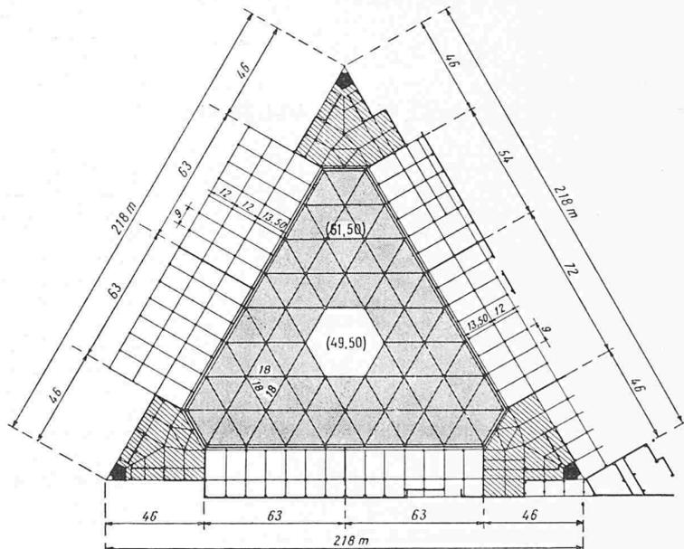
Anordnung der Trägerachsen im mittleren Boden (Kote + 12 m, Dreiecknetz) und in den Seitenbauten (Rechtecknetz, vier Geschosse). Masstab 1:3000
