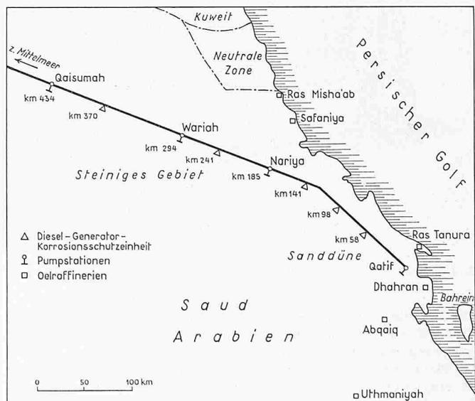
Bild 1. Südöstlicher Abschnitt der in Saudi-Arabien verlegten Trans-Arabian-Pipeline
