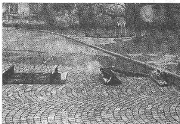
Nach 17 Minuten fiel das ungeschützte Dach zusammen — das mit «ALBI-SKK» behandelte Dach konnte nach 30 Minuten praktisch unverändert weggetragen werden.
