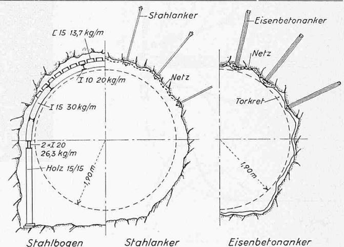
Bild 19 (rechts). Die drei untersuchten Bauweisen
