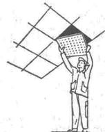
ZENT-FRENGER-Decke ist ihre unbeschränkte Zugänglichkeit: Leitungen für Elektrizität usw. können unsichtbar, aber immer zugänglich, montiert werden! — Wärme strahlt aus der Decke, wie die Sonne vom Himmel...
