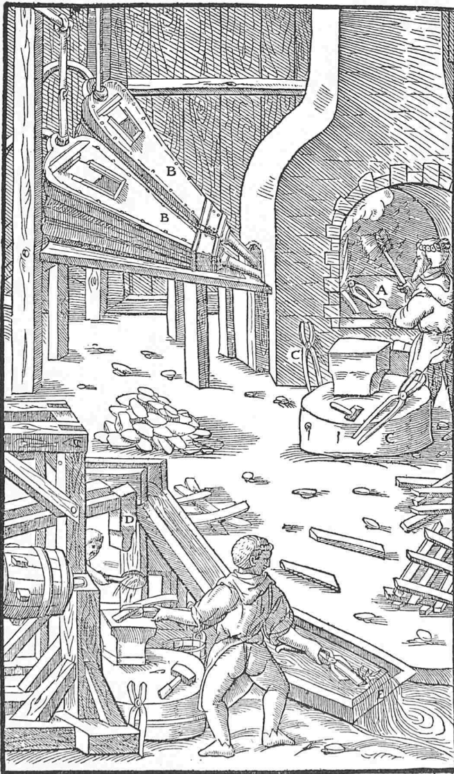
Bild 4. Frischfeuer. A Frischfeuer, B Blasebälge, C Zangen, D Hammer, E fliessendes Wasser
