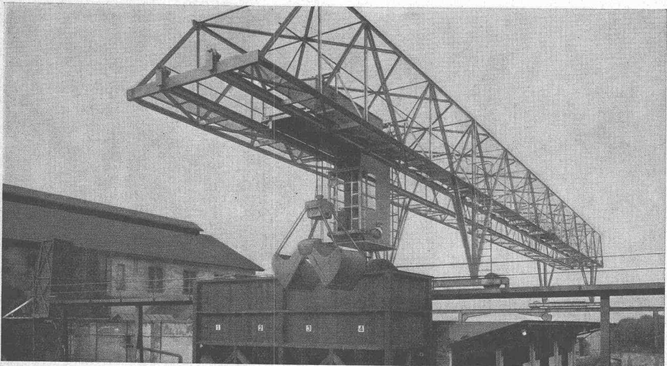
Verladebrücke in Schweisskonstruktion 2,5 t Tragkraft, 46 m Länge
