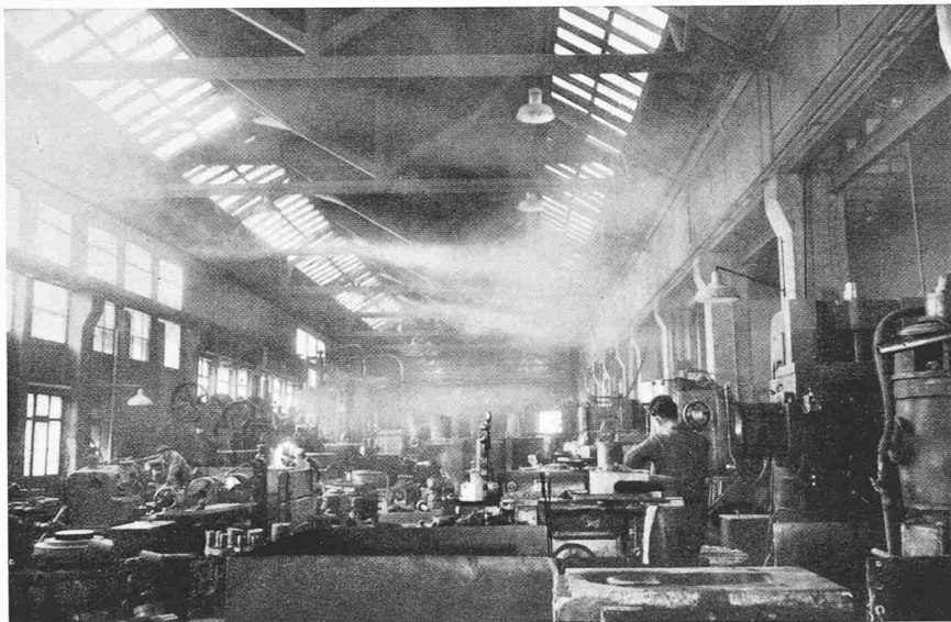
Bild 13. Die durch Raumentwicklung sichtbar gemachte Raumluft steigt entsprechend der künstlichen Entlüftung mit etwa 1 m/min. gleichmässig nach oben
