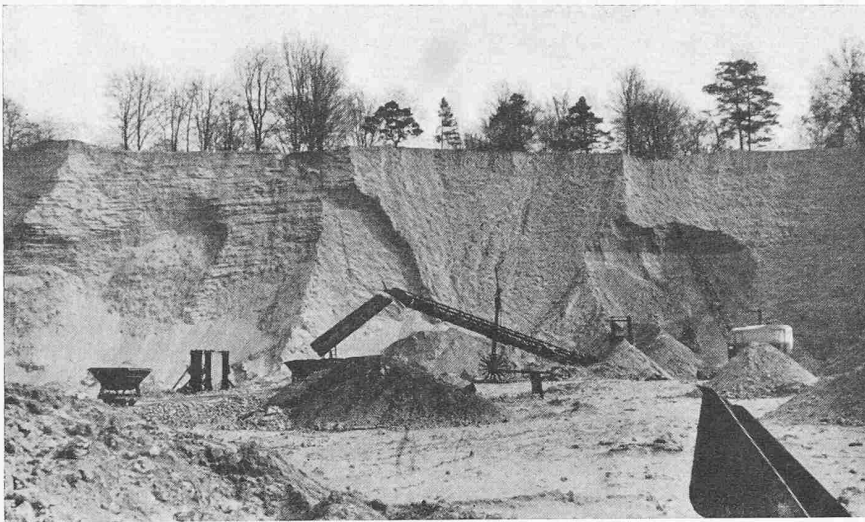
Bild 1. Grube Tilly bei Waterloo. Quarzsand mit rd. 96 % SiO 2 , Schichthöhe rd. 15 m
