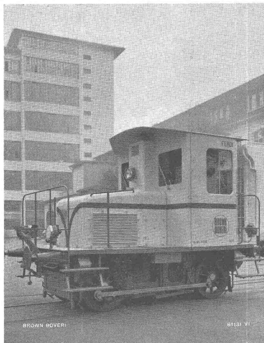
Bild 2. Dieselelektrische Rangierlokomotive für die Bedienung von privaten Anschlussgleisen und für den Werkrangierverkehr. Da der Dieselmotor auch in kurzen Betriebspausen abgestellt werden kann, ist dieses Fahrzeug sehr wirtschaftlich.
