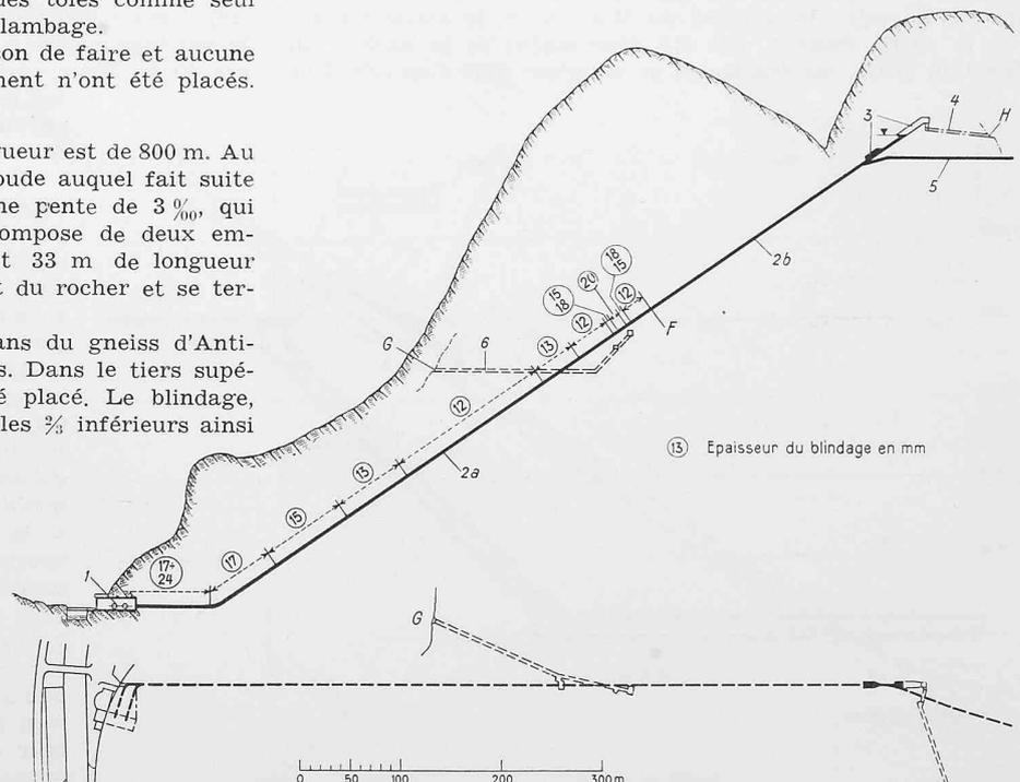
Fig. 1. Schéma du puits incliné de la Centrale de Gondo, plan et profil en long
