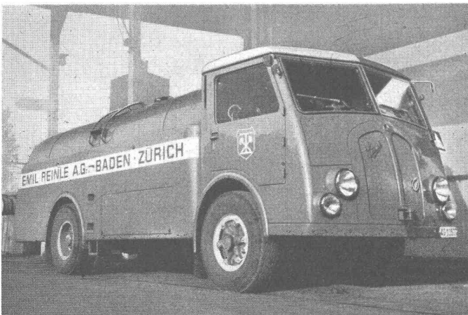
Saurer-Tankwagen, Typ S4C-H, Radstand 4100 mm, Tankinhalt 9800 l, mit 8-Zyl. Dieselmotor, Typ. CH2D, effektive Leistung 160 PS.
