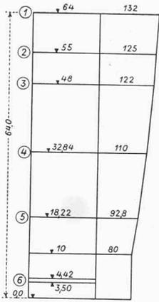
Bild 6. Winddruck  $q$  in Funktion der Höhe
