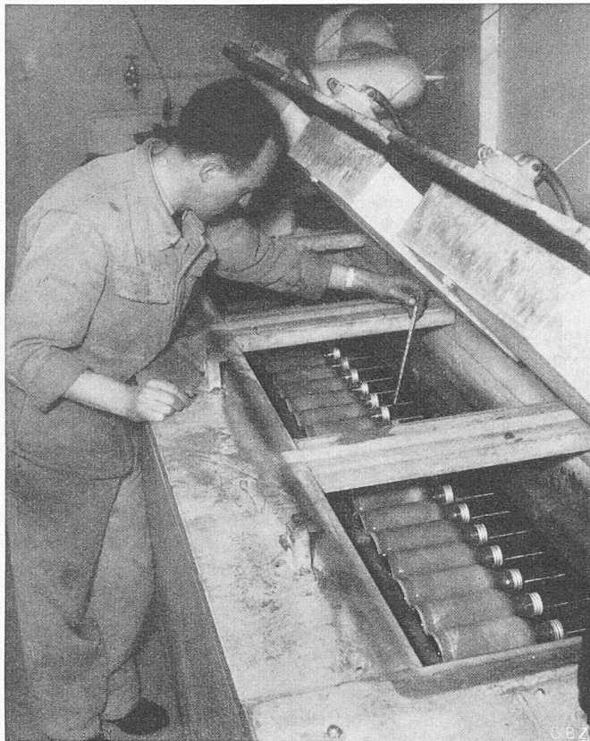
Bild 8. Ansicht des Plasmagefrierapparates mit geöffnetem Deckel
