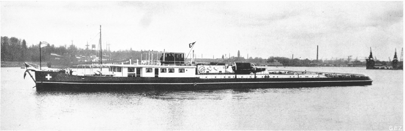
Bild 3. Das Rhein-Motor-Schleppschiff «Uri» der Schweizer. Reederei A.-G. in Basel mit vier Sulzer-Dieselmotoren von zusammen 3600 PS bei 350 U/min. Das Schleppschiff «Unterwalden» sieht äusserlich genau gleich aus
