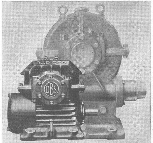
Sonderkühlung, Öelumlaufschmierung für Getriebe und Lager, David Brown Schnecken Zahnform, hohe Leistung und Wirkungsgrad bei kleinsten Abmessungen, niedrigerer Preis als für gewöhnliche Schneckengetriebe gleicher Leistung, zuverlässig, geräuschlos.
