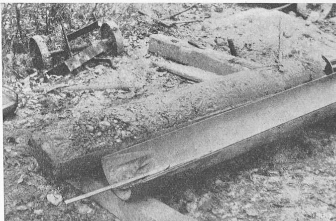
Bild 4. Mit dem Bohrpfahl erhaltener Kern aus Kies und Sand vor Herausnahme aus dem geöffneten Kernrohr (Bohrung 15)
