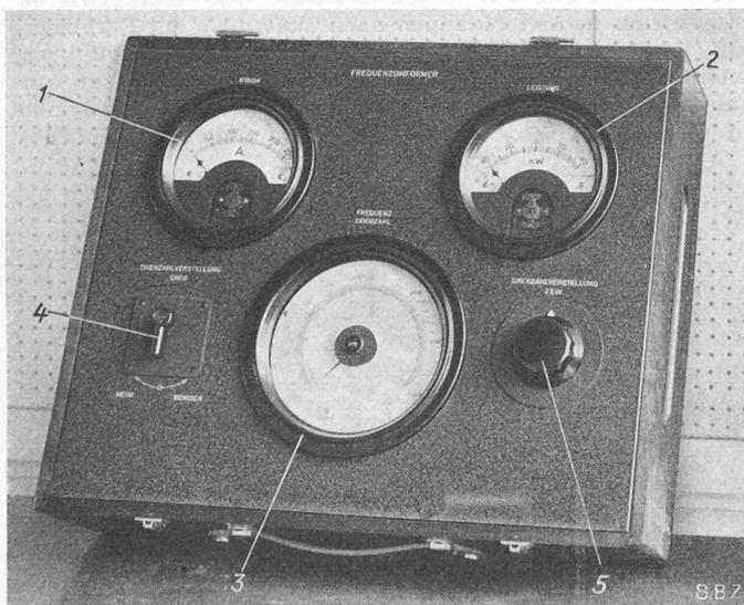
Bild 21. Tragbarer Steuerkasten für die Propellermotoren (Bild 26, Seite 568). 1 Ampèremeter der Propellermotoren, 2 Wattmeter der Propellermotoren, 3 Tachometer, 4 Drehzahleinsteller grob, 5 Drehzahleinsteller fein
