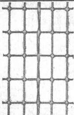
**Drahtziegelgewebe und Streckrabitz** die beiden bevorzugten Putzmörtelträger
