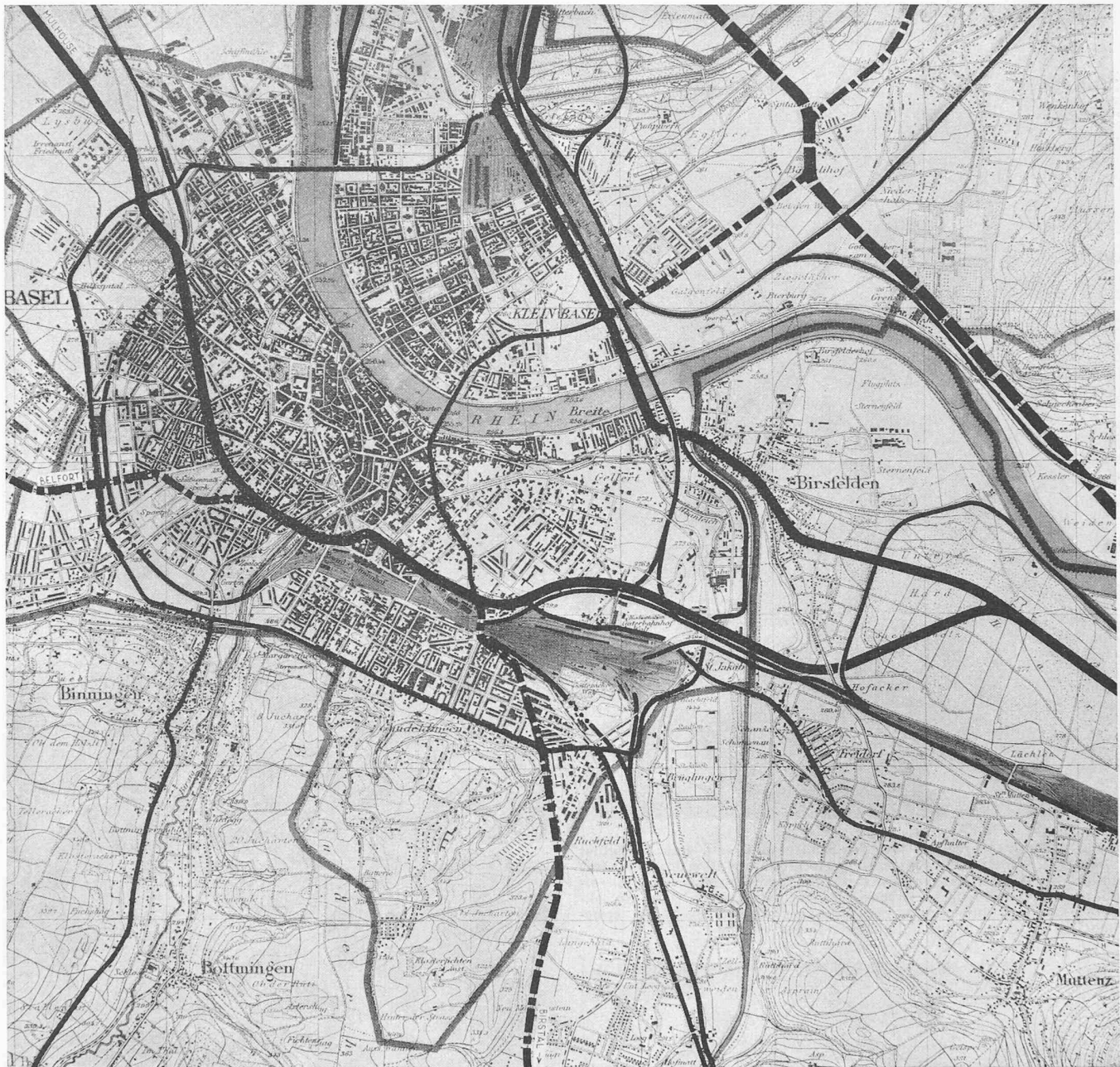
Bild 1. Hauptlinienplan der Basler Verkehrsstrassen, 1:40000. Die Breite der Striche entspricht der Bedeutung der Strassen. Gestrichelt = Strasse internationaler Bedeutung; strichpunktiert = Strassen der Grossregion Nordwestschweiz-Oberrhein
