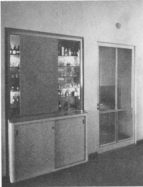
Bild 9. Apothekenschrank mit automat. Innenbeleuchtung beim Öffnen der Opakglas-Schiebetüren
