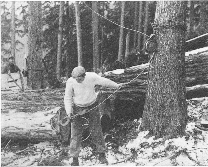
Bild 3. Verwendung des Kabelkrans zum Anschleppen von Baumstämmen an die Ladestelle, hinten Telephonist
