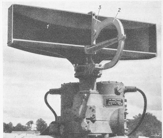
Bild 1. Antenne mit rotierendem «Kässchnitt»-Reflektor. 1 Reflektor, 2 Wellenleiter, 3 Trichter zum Einstrahlen der elektrischen Wellen in den Reflektor
