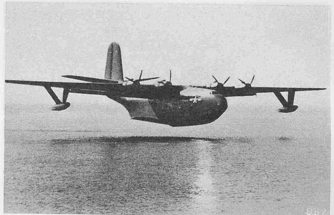
Abb. 11. «Mars-Mammoth» von Glenn Martin, Wasserflugboot von 80 t mit vier Motoren von je 3500 PS Startleistung, 108 Passagiere
