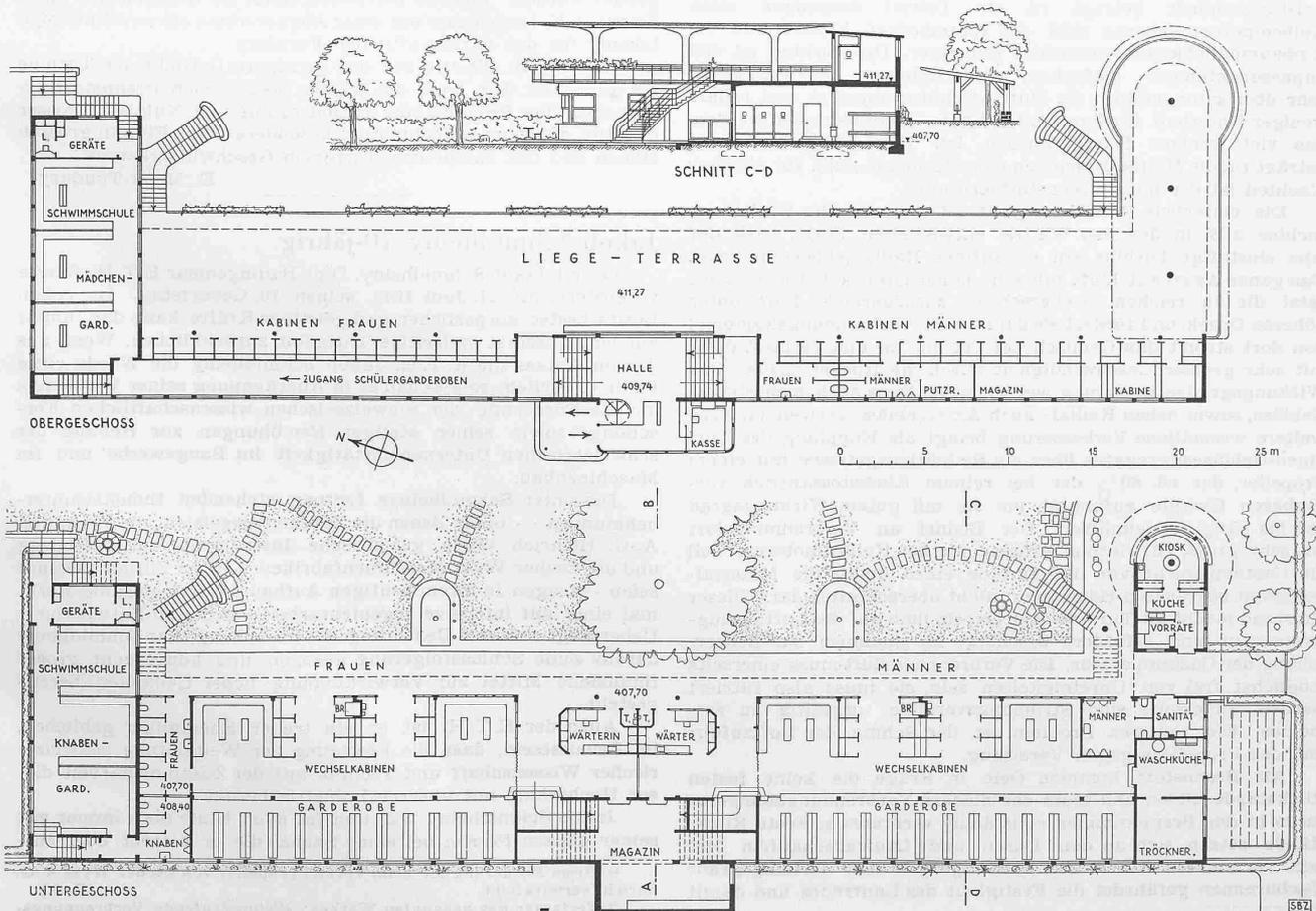
Abb. 2 bis 4. Badenstat Zürich-Wollishofen. Arch. † H. HERTER, Stadtbaumeister. — Grundrisse und Schnitt C-D, Masstab 1:400
